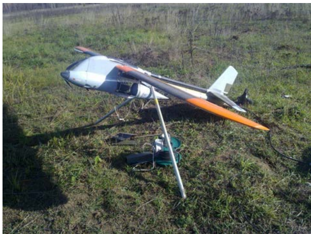
Рис. 2. Беспилотный летательный аппарат Птрео-Е, применявшийся для выполнения экспериментальных съемок тестовых участков
